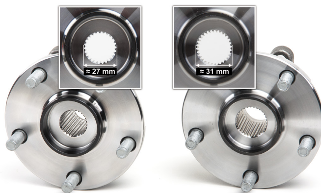
Obrázek 2: Průměr uchycení poloos je rozdílný
