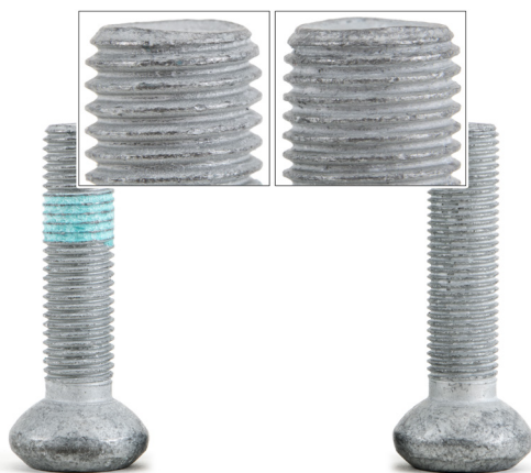
Obrázek 1: Levý šroub: M12x1,5 Pravý šroub: M12x1,25
