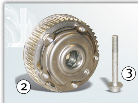
Obrázek 2: Seřízení vačkové hřídele na straně výfuku 427 1005 10 a centrální šroub 41301*
