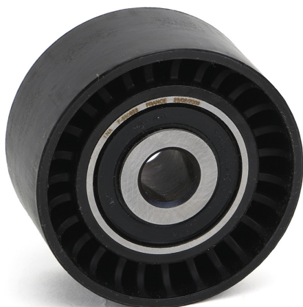
Obrázek 1: Staré provedení s plastovou dosedací plochou
