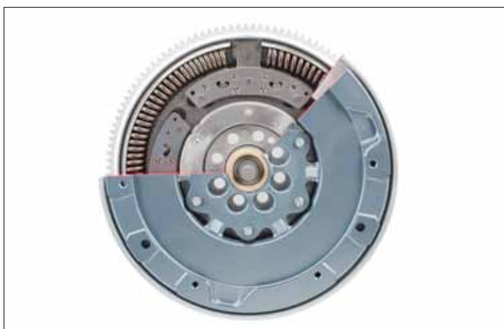
Obrázek 1: Dvoumotový setrvačnick s odstředivým kyvadlem v řezu
