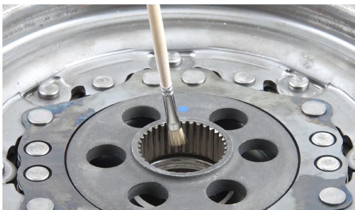
Obrázek 1: Vnitřní ozubení dvoumotového setrvačnicku by mělo být při každé opravě mírně namazáno
