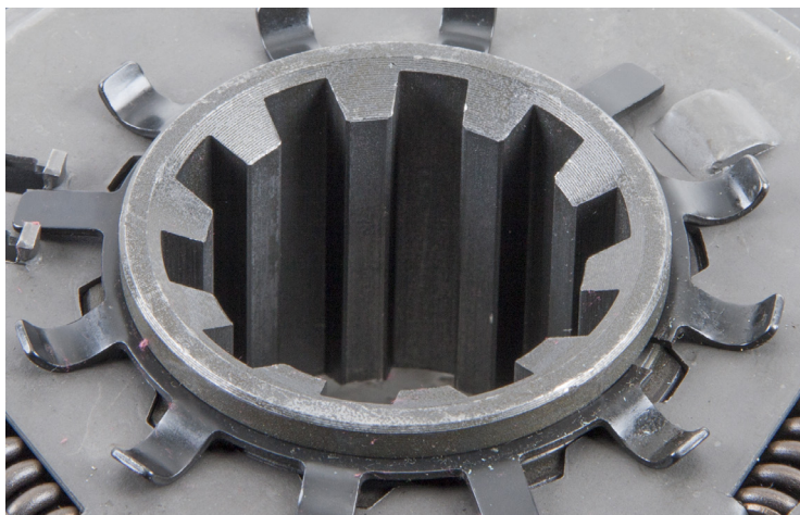
Obrázek 2: Fosfátované náboje je třeba namazat
