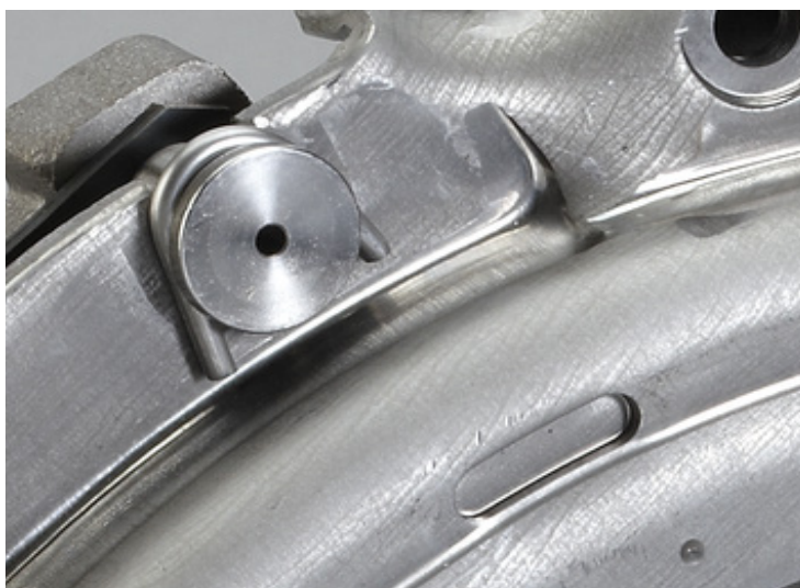
Obrázek 2: Vložte montážní třmen mezi stupňovité svorníky a skříň spojky
